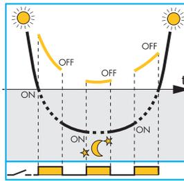
Неверная работа, где лампы работают циклически между Вкл и Выкл, т.к. этот эффект был замечен сенсором
