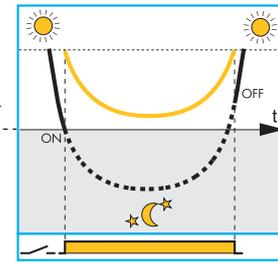
Инновационная технология "компенсация засветки" позволяет избежать раздражающих и причиняющих вред эффектов частых ламповых колебаний между Вкл и Выкл из-за плохой их установки
