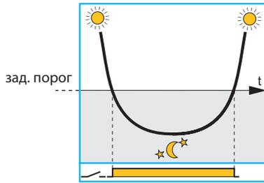
Правильная работа - при усл., что сенсор экранирован от эффектов контролируемого освещения. Вкл и Выкл
