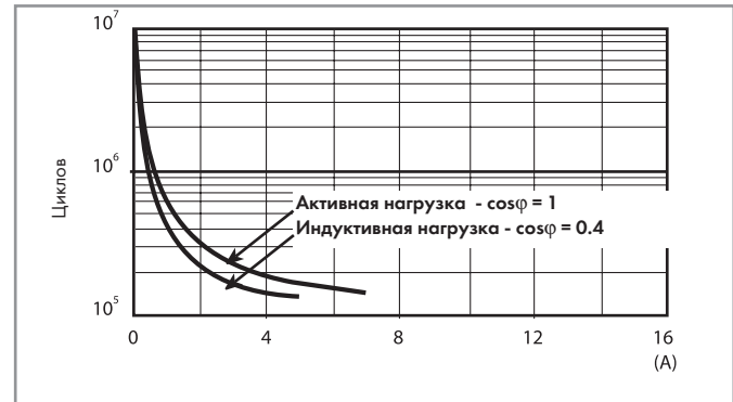
F 59 - Электрическая долговечность (АС) при ном. нагрузке Реле с 4 перекидными контактами
