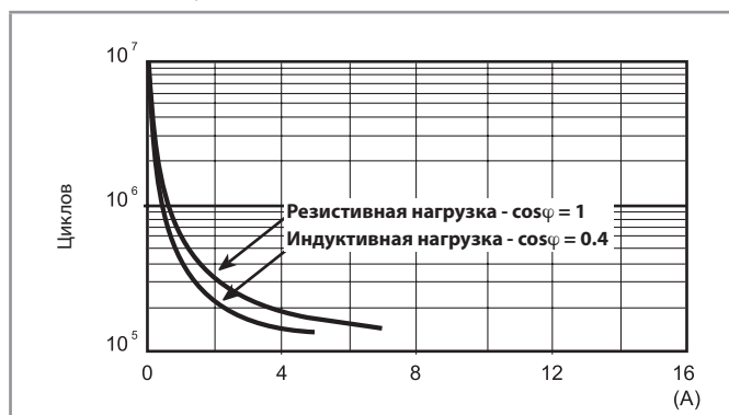
F 58 - Электрическая долговечность (AC) при ном. нагрузке Реле с 4 перекидными контактами
