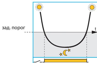
Правильная работа - при усл., что сенсор экранирован от эффектов контролируемого переключения освещ. Вкл и Выкл
