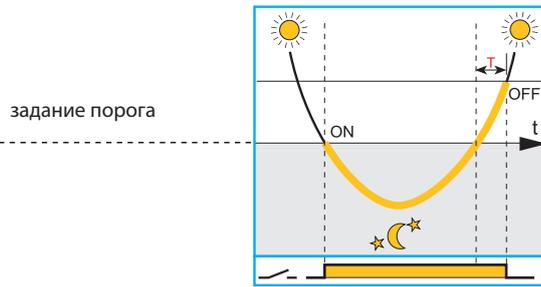
"Традиционные" реле вкл. света имеют гистерезис переключения для предотвращения неправильной работы
