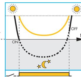
Запатентованная технология "компенсация засветки" позволяет избежать раздражающих и причиняющих вред эффектов частых ламповых колебаний между Вкл и Выкл из-за плохой их установки
